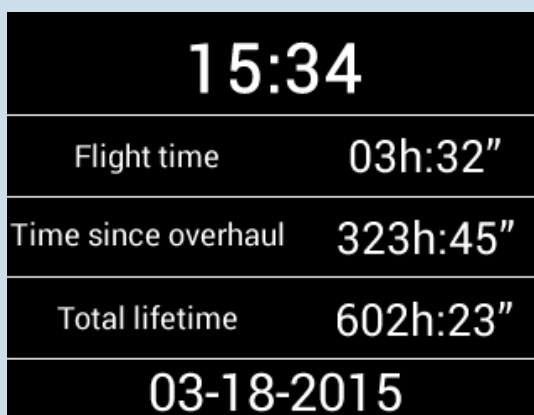
Pagina Orologio: Include il tempo di volo, il tempo di vita e il tempo trascorso dall'ultima revisione.
